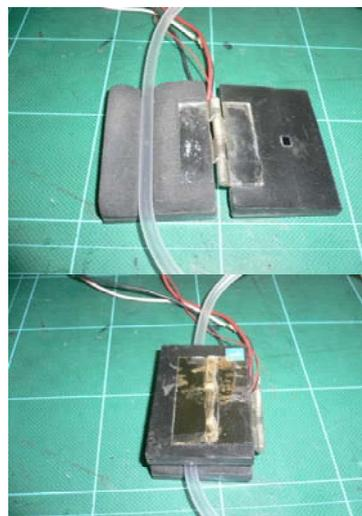
ビニールチューブを挟んで発光ダイオードの光がチューブにあたり、透過した光ダイオードで検出する。
