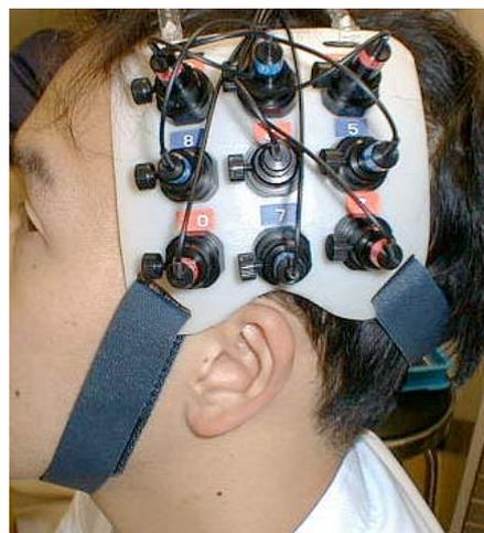
図 9 の配列で赤が光源、青が受光ファイバーである。各、光源の光はそれぞれ異なった周波数で振幅変調されているため、受光ファイバーに入った光がどの光源から来た光かを弁別可能である。
